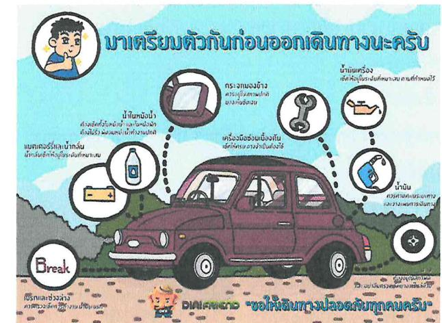
รถรุ่นใหม่ให้ผู้ใช้รถตรวจสภาพรถก่อนออกเดินทาง เพื่อเพิ่มความปลอดภัยด้านพาหนะ เช่น ตรวจสอบดับน้ำมันในแบบเตอร์ ตรวจระดับน้ำในถังพักน้ำ ตรวจระดับน้ำมันเบรคและน้ำมันเครื่อง เป็นต้น
